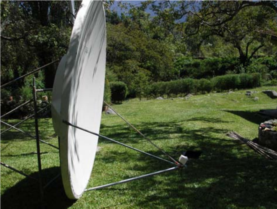
Figura 11.29: Refletor e seu alimentador, focando uma antena de 12 dBi, apontando 14° para baixo. A direção da elevação real resultante é de 8° para cima.
