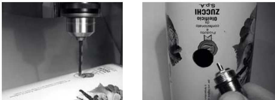
Figura 4.36: Com cuidado, faça primeiro um furo guia, depois use brocas maiores para terminar o trabalho.
