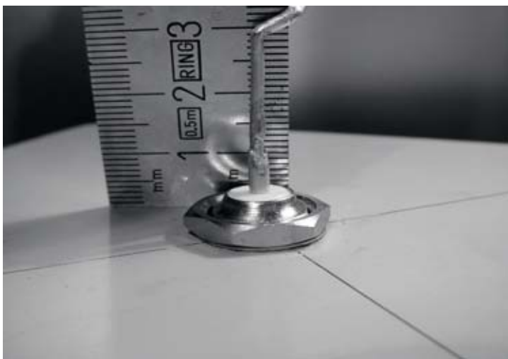
Figura 4.26: A primeira espira deve começar a 3,0 cm da superfície da placa.
