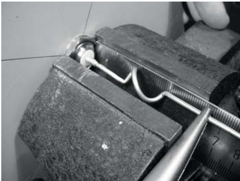
Figura 4.27: Esticando as espiras. Seja cuidadoso e tente não arranhar a superfície do fio com o alicate.
