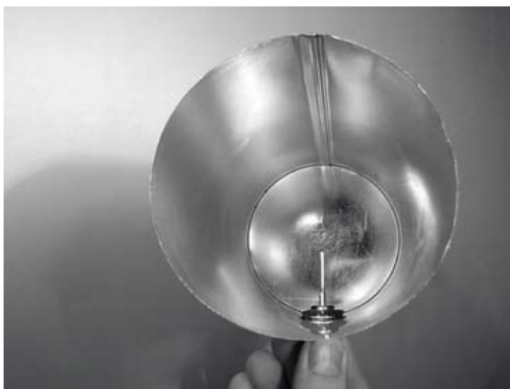
Figura 4.41: Sua antena concluída.
