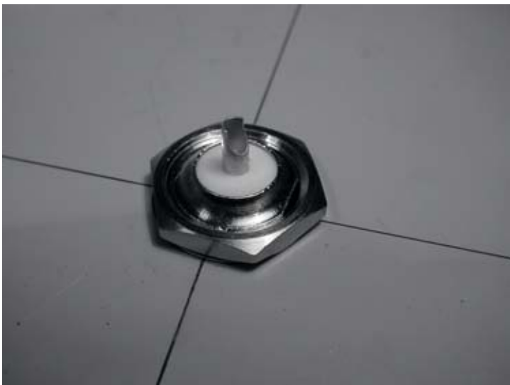
Figura 4.24: Firme bem o conector N à placa.
