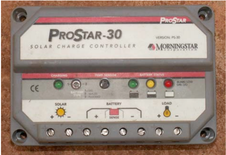
Figura 7.3: Um controlador de carga solar de 30 Amp.
