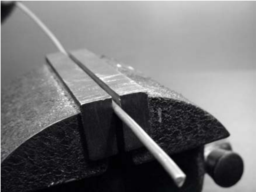
Figura 4.14: Endireite o fio, tornando-o o mais reto que conseguir.
