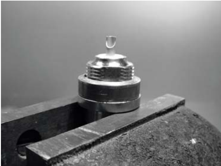
Figura 4.23: A adição de um espaçador feito a partir do cano de cobre ajuda a casar a impedância da antena em 50 Ohms.
