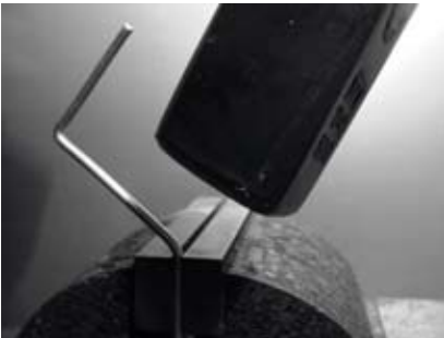
Figura 4.16: Dobre o fio na forma de um 'Z'.
